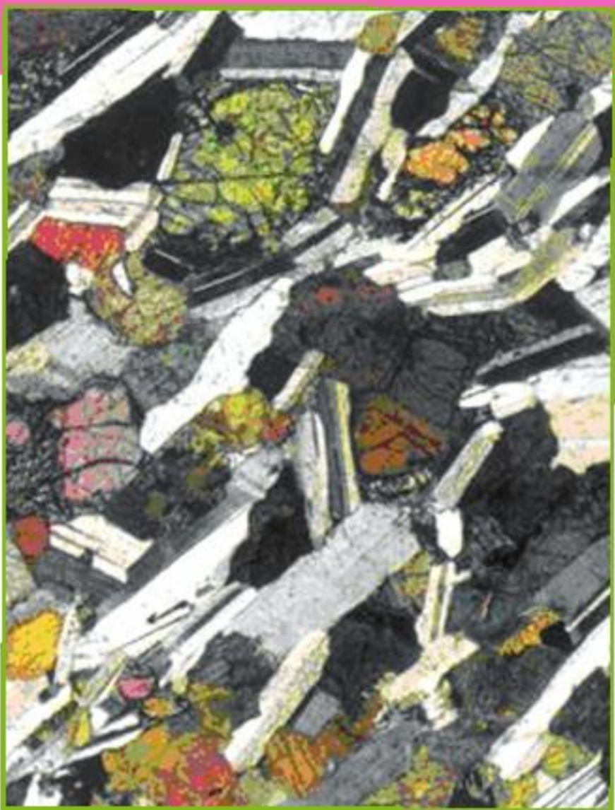
شکل ۲- الیوین گابرو در نور پلاریزه با آنالیزور- بزرگمایی ۹ برابر
