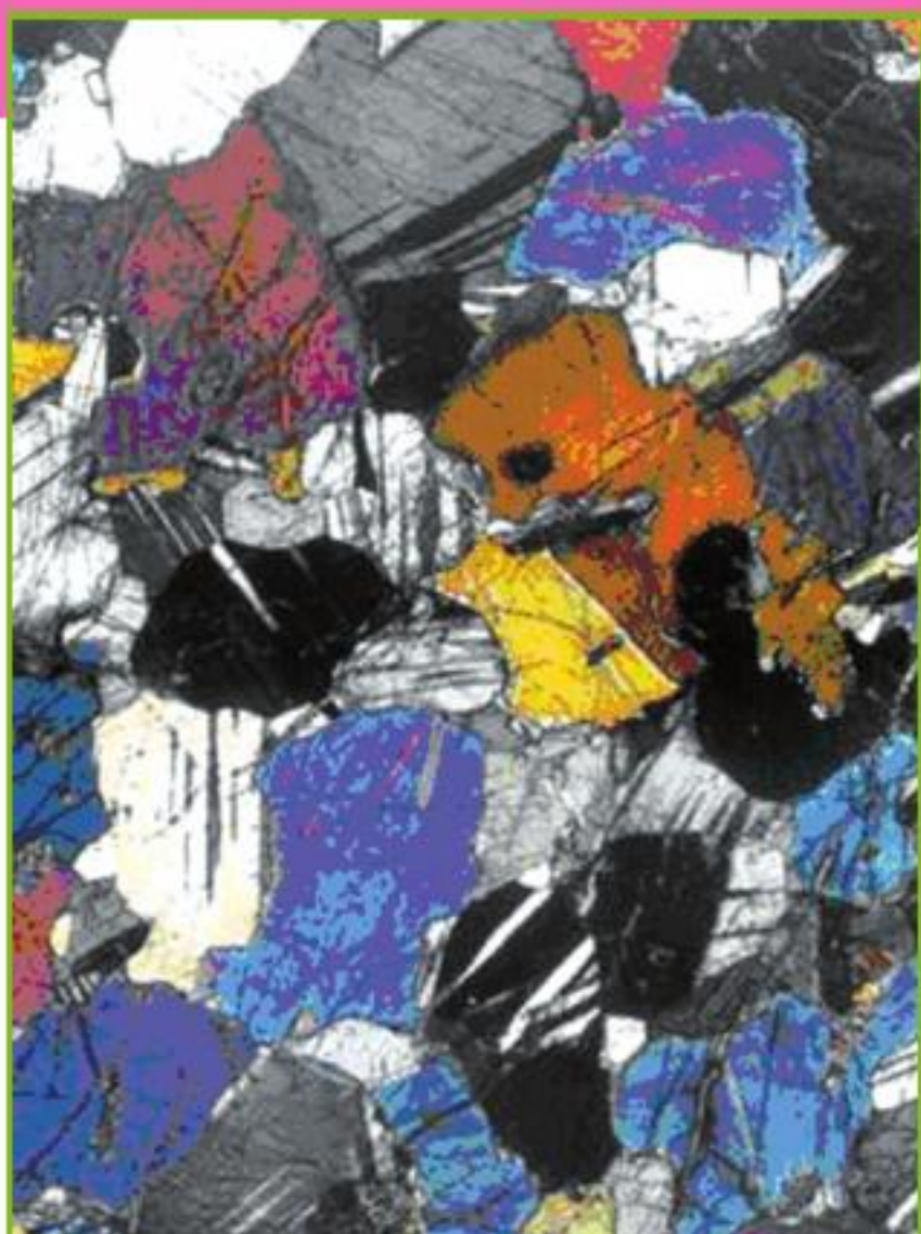
شکل ۴- گابرو در نور پلاریزه با آنالیزور با بزرگی ۱۱ برابری
