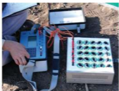
شکل ۶- اتصال دستگاه SWITCH BOX
