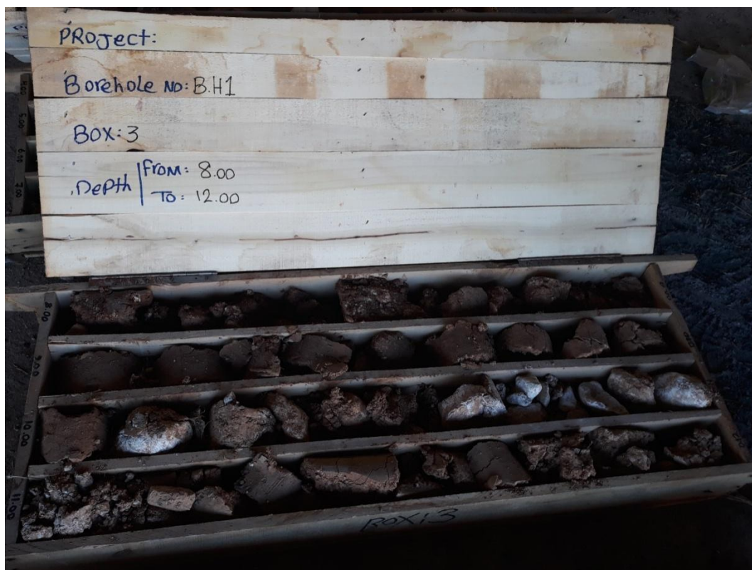
نگاره ۱: رس قهوه‌ای و گچدار از ژرفای ۸ تا ۱۲ متر مرطوب
